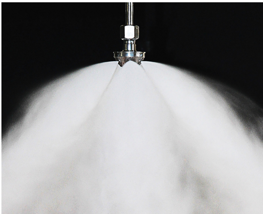
Bei einer Hochdruck-Wassernebel-Anlage wird das Wasser, bei einer Leistung von 3 bis 25 l/min. je Düse, fein vernebelt.
